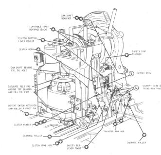
∷OIL ALL ROLLER PIVOT : ∷:BEARINGS — 1 OR 2 DROPS ::
