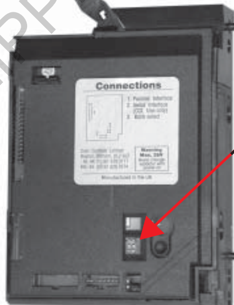
Schalterstellung für Münzannahme der derzeitigen Landeswährung
