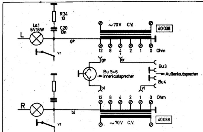
Circuit de sortie pour amplificateurs avec impédance transformateurs.
